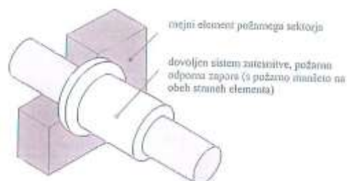
Prehod gorljivih cevi skozi požarni zid
